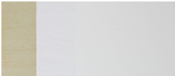
Anstrichaufbau Standölfarbe weiß Grundieröl - Zwischenanstrich - Schlußanstrich
